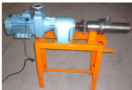
شکل ۵- نمایی از دستگاه پرس با مارپیچ دوار (نمونه ساخته شده)
